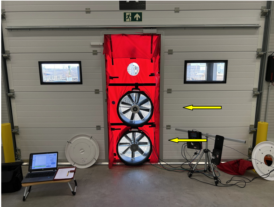
2 db Minneapolis ventilátor a csarnok egyik DNy-i kapu ajtónyílásába lett beszerelve.
