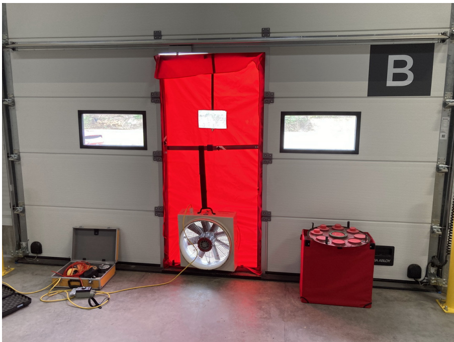
A Retrotec mérőberendezés a másik ipari kapu ajtónyílásába lett felszerelve.
