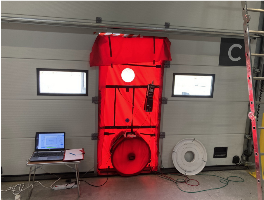
A Minneapolis mérőberendezés az egyik ipari kapu ajtónyílásába lett felszerelve.
