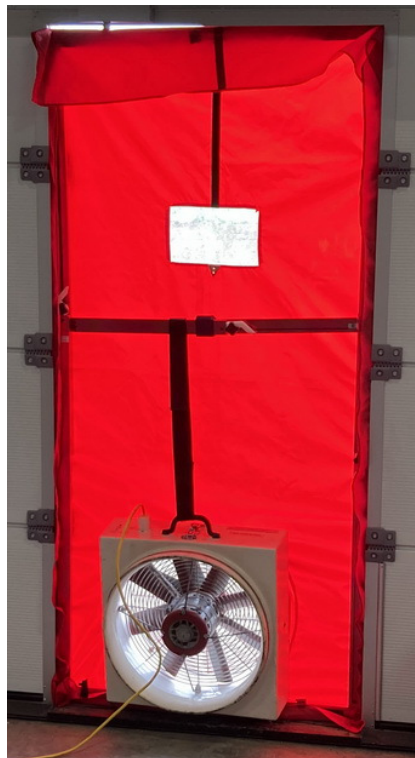
A Retrotec mérőberendezés a másik ajtónyílásba lett felszerelve.
