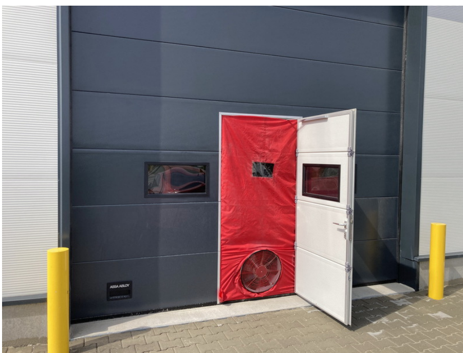
A Retrotec mérőberendezés a másik ipari kapu ajtónyílásába lett felszerelve.
