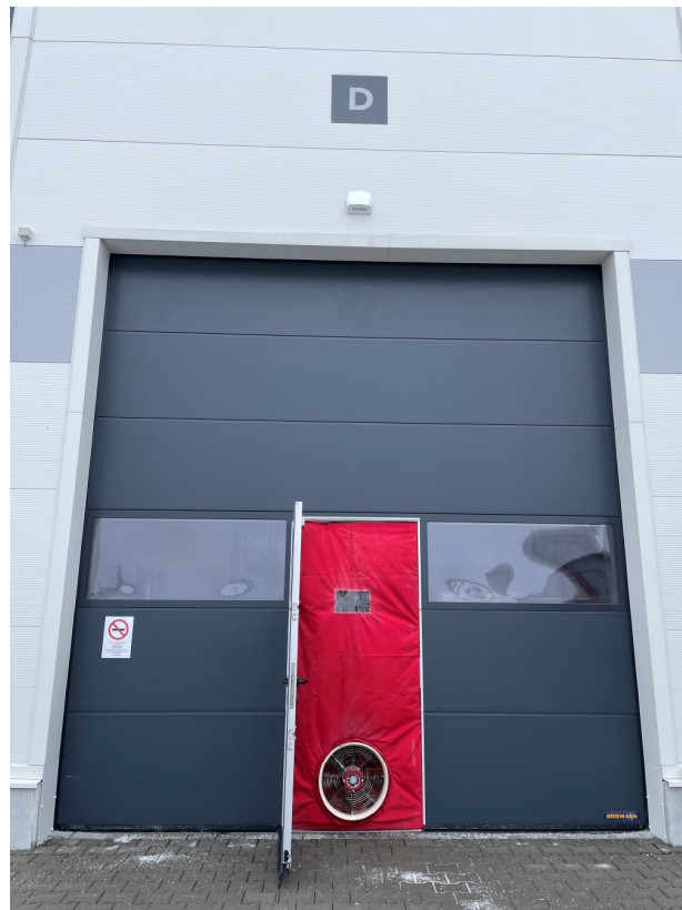
A Retrotec mérőberendezés az egyik ipari kapu ajtónyílásába lett felszerelve.
