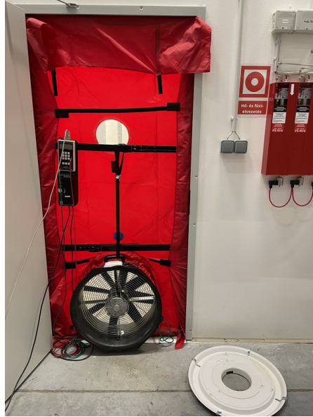
A Minneapolis mérőberendezés az iroda ajtónyílásába lett felszerelve.
